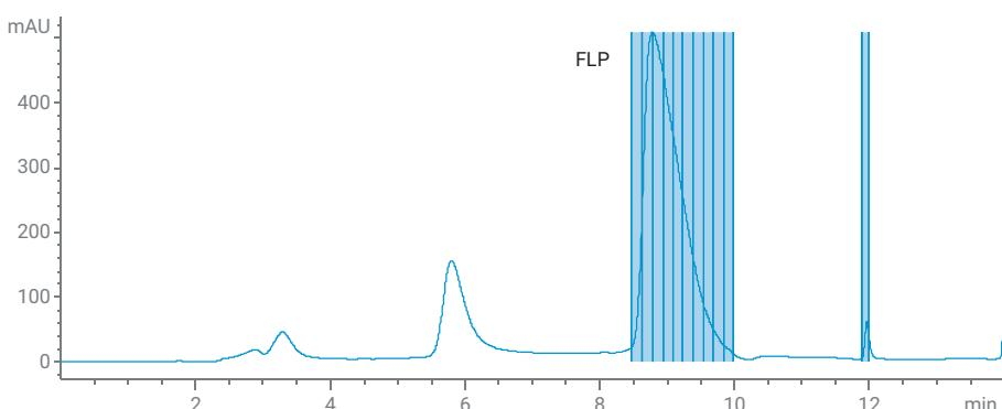
図 1. 分取カラムでの 4 mL (20 mg オンカラム) 注入のクロマトグラム (UV 260 nm)。
