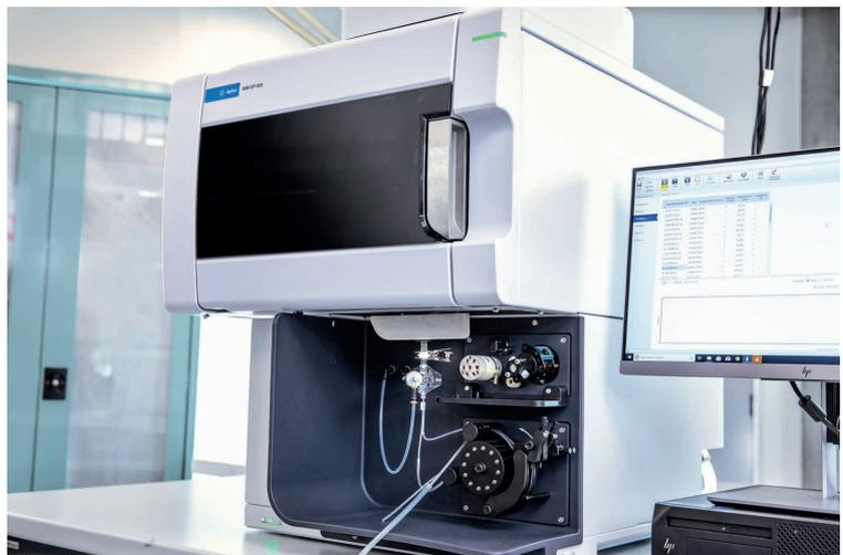
EPA 200.7 メソッドでの測定に使用可能な Agilent 5900 ICP-OES
