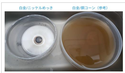
10% 王水マトリックスで、18 時間分析した後のコーンの写真。白金/ニッケルめっき（左）のクリーニングサイクル：超音波洗浄器での 25 分間の水循環を 1 回、拭き取り。白金/銅コーン（右・参考）のクリーニングサイクル：超音波洗浄器で 25 分間の水循環を 1 回、その後 2% のシトラロックス溶液中で 5 分間。超音波洗浄器で 25 分間の水循環を 2 回、拭き取り。
